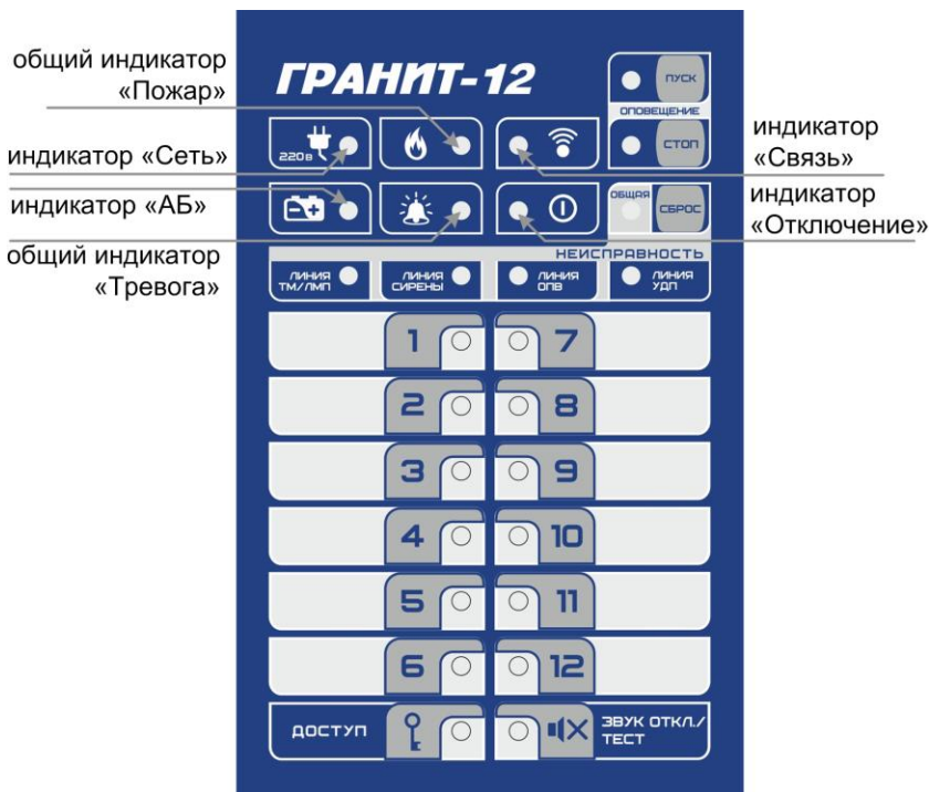
Рис.2 Панель индикации и управления прибора Гранит-12А GSM
